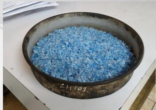
**Figura 1:** Se tomo una muestra de PET en una charola de lámina la cual se le realizo un proceso de secado para evitar humedad y que altere los porcentajes de la dosificación.
