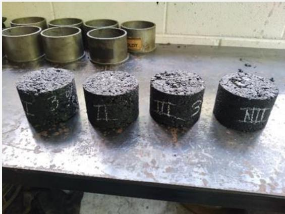
**Figura 8:** Con el extractor de muestra se desmoldan los cilindros de las briquetas.
