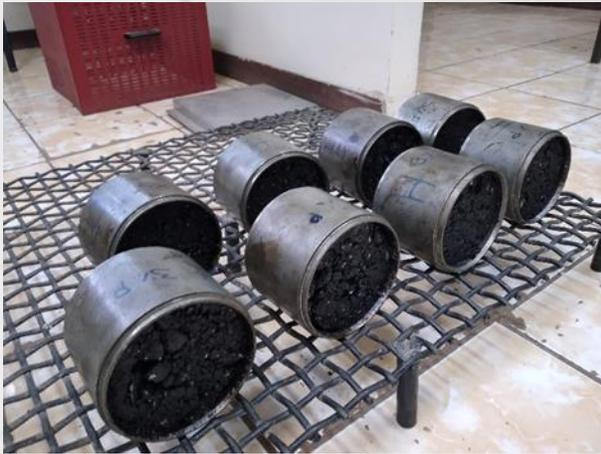
**Figura 7:** Briquetas de 3% y 5% de PET en reposo para su enfriamiento.
