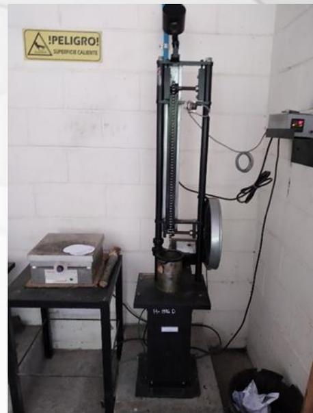
**Figura 6:** En el martillo compactador mecánico, se vuelve a tomar la temperatura con un termómetro digital la cual tiene que estar entre 147°-152°C para
