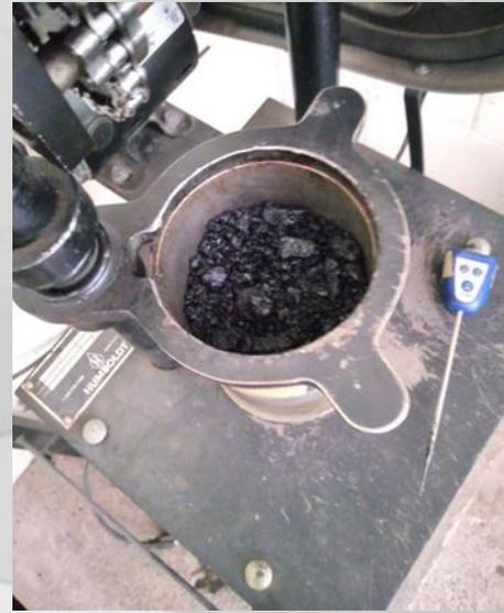
**Figura 5:** Se compacta la mezcla en el martillo mecánico, la temperatura esperada tiene que ser entre 158° a 163°C, se pincha alrededor de la mezcla 15 veces y 10 en el centro, y luego se coloca 2 filtros.
