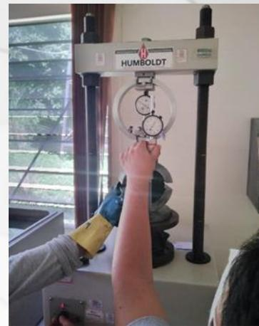
**Figura 10:** Se colocó el cilindro al anillo de carga, y se centra en el aparato de carga.
