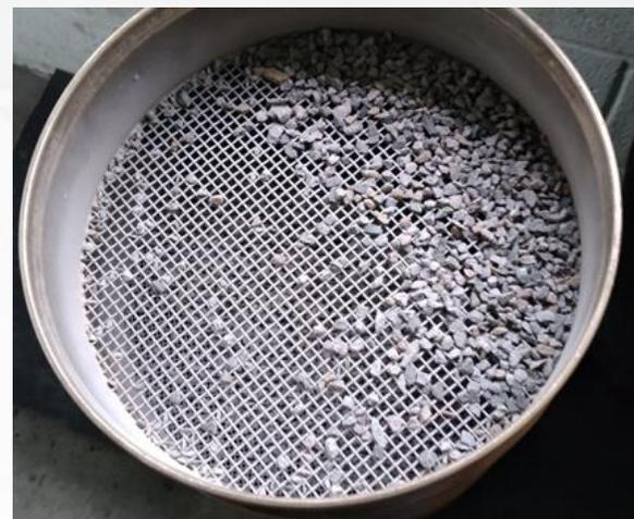
**Figura 2:** Proceso de tamizado, para separar el diámetro de los agregados pétreos gruesos y finos.
