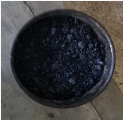
**Figura 4:** Se mezcla de forma homogénea cubriendo con la brea asfáltica, siempre manteniendo el calor de los materiales con una cocina.
