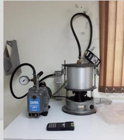
**Figura 9:** Se realizó el método de ensayo estándar para gravedad Especifica BULK y densidad de la mezcla compactada no absorbente en el picnómetro, para lo cual se necesitó: recipiente de vacío, bomba de vacío, barómetro y dispositivo de agitación mecánica.
