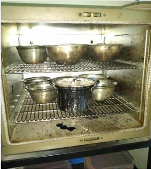
**Figura 3:** La brea asfáltica, los agregados pétreos y el PET se dejaron toda la noche en el horno entre 162° a 164°C.
